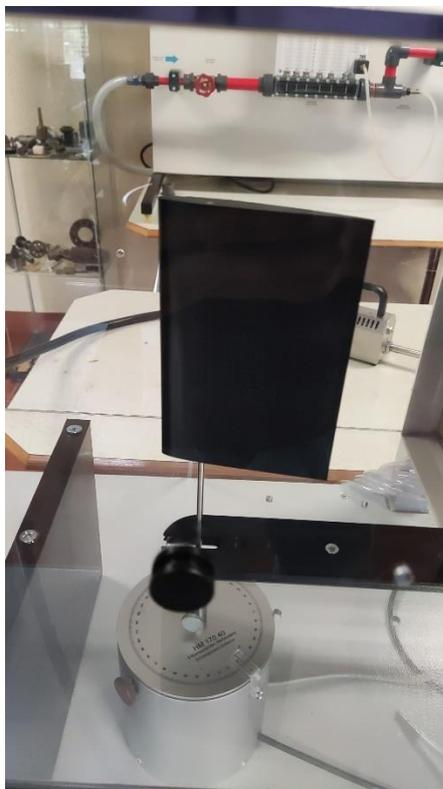
Figura 33 - Modelo na secção de testes do túnel de vento.
