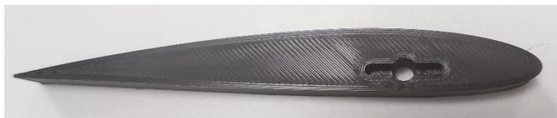
Figura 24 - Impressão de um corte de secção a meio de um modelo para verificar o encaixe da vareta.
