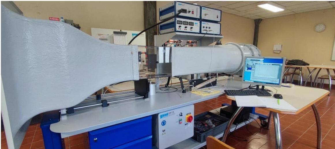
Figura 32 - Túnel de vento com um modelo pronto para testes.
