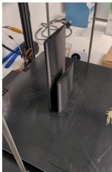
Figura 25 -Impressora (esquerda) e dois perfis alares acabados de imprimir (direita).
