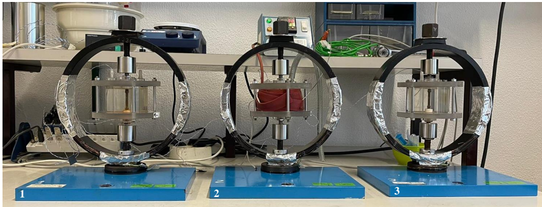
Figura 32 – Fotografia promenorizada das 3 células de ensaio. [1] Célula para a condição de ensaio a 1,5\sigma_{Ser(T_{amb})} , [2] Célula para a condição de ensaio a 0,5\sigma_y (\pm 60^\circ C) , [3] Célula para a condição de ensaio a 0,5\sigma_y (T_{amb}) .
