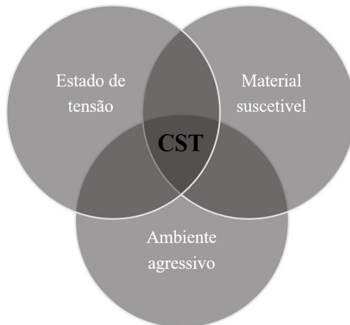
Figura 7 – Condições para ocorrência de CST. Adaptado de (Cheng, 2013)
