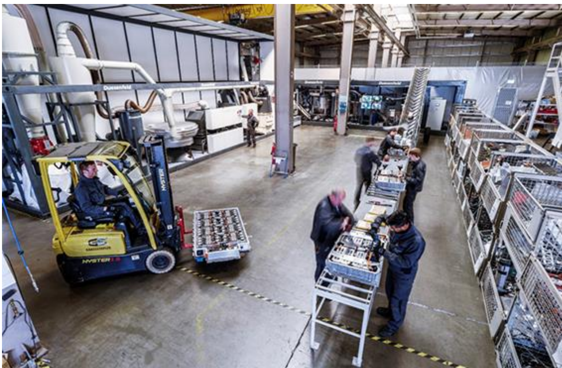
Fig. 31 – Central de reciclagem de veículos a bateria na Alemanha, adaptado de [10]
