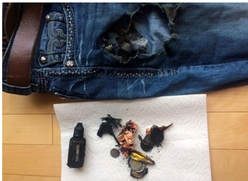
Fig. 28 - Calças de ganga queimadas, no qual uma célula de íões de lítio entrou em contacto com moedas soltas no bolso, adaptado de [10]
