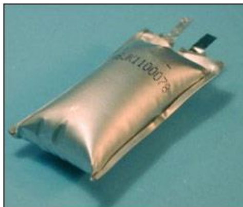
Fig. 22 – Célula de bolsa inchada, adaptado de [10].
