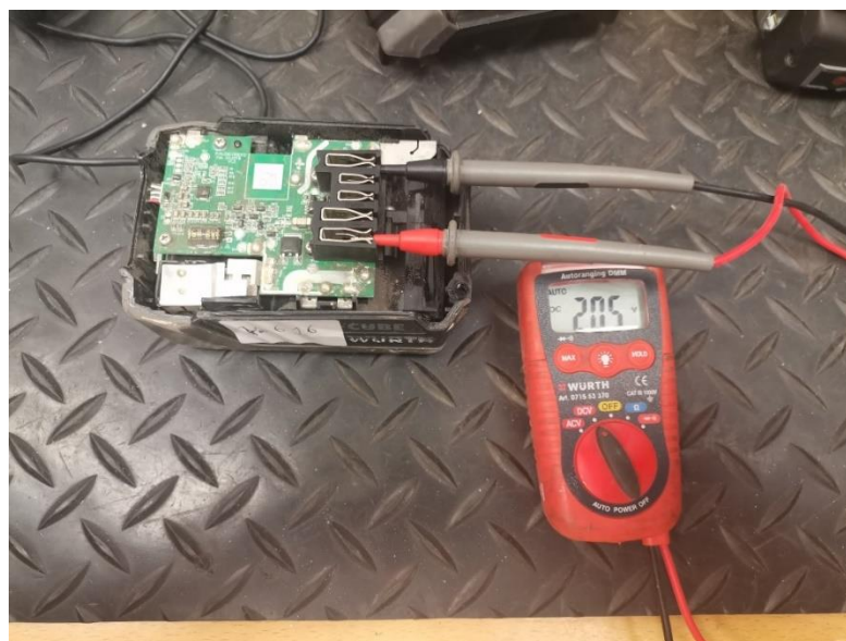
Fig. 40 – Procedimento de medição de voltagem com multímetro
