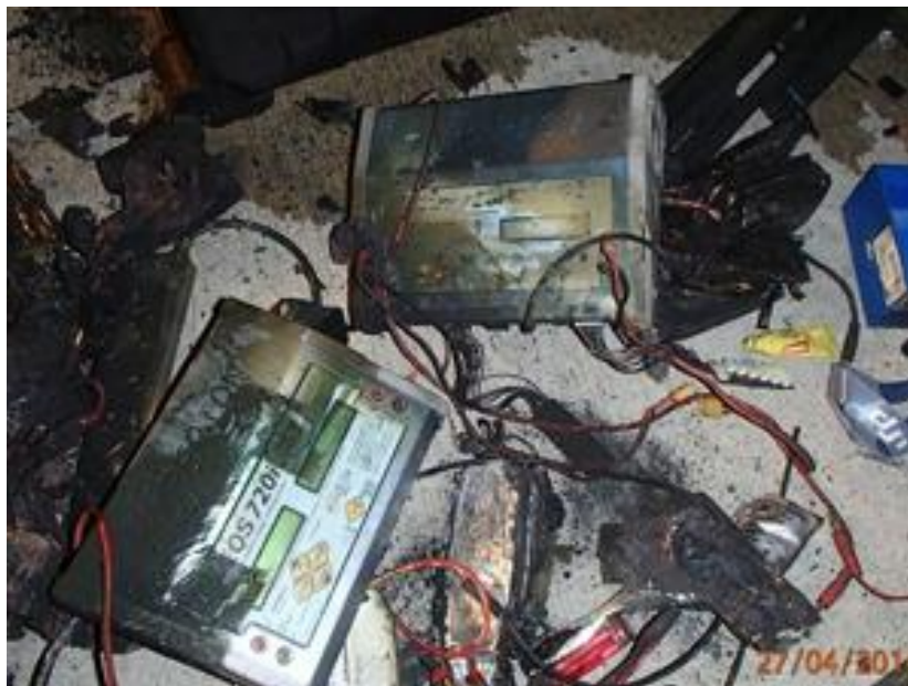
Figura 26 – Baterias de ião-lítio que explodiram no compartimento de carga de uma aeronave, adaptado de [10].
