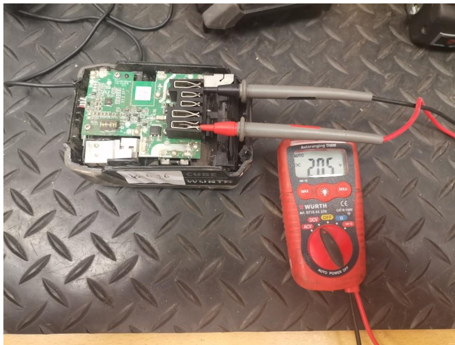
Fig. 46 – Verificação de voltagem e estado visual da BMS
