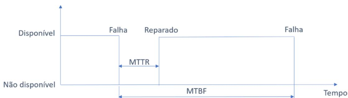
Figura 7 - Esquema de interpretação dos conceitos de MTBF e MTTR. Adaptado de (Ben-Daya et al., 2009)
