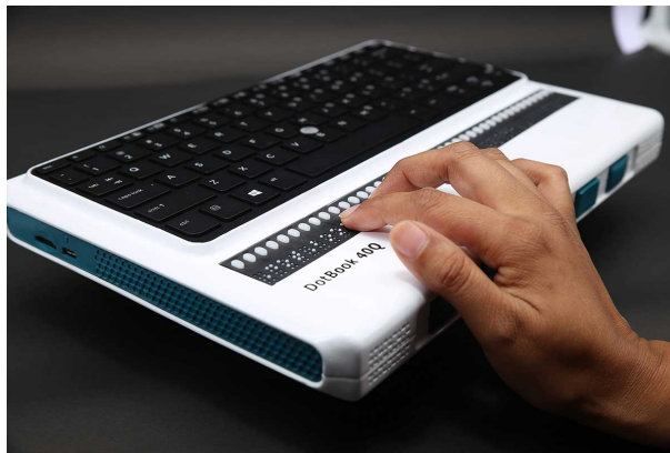
Figura 8 - Laptop DotBook com saída de 40 células Braille
