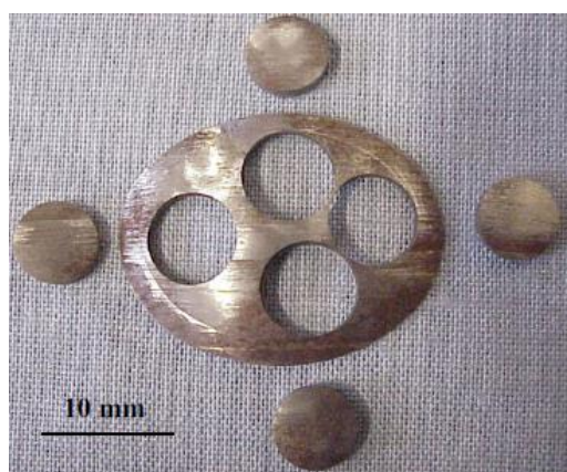
Figura 15 – Provetes SP obtidos a partir de uma amostra removida pelo equipamento da Rolls-Royce (CEN, 2006).
