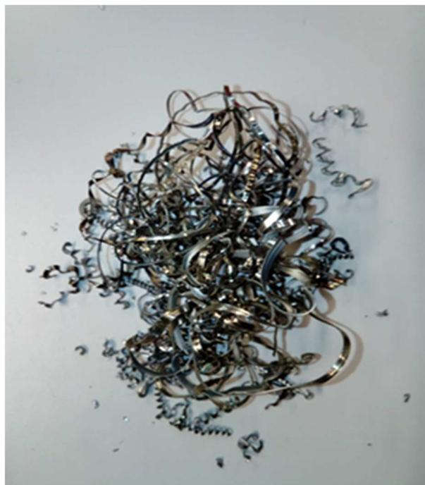
Figura 12- Limalha do tubo do lote TM (tubo com má maquinabilidade).
