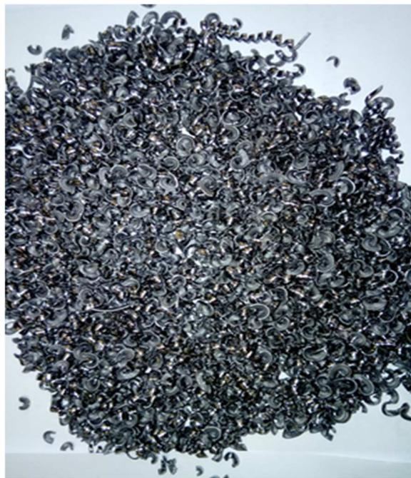
Figura 11- Limalha do tubo do lote TB (tubo com boa maquinabilidade)
