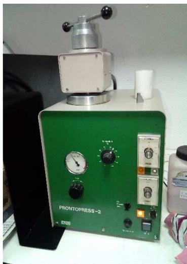
Figura 6- Prensa metalográfica Struers Prontopress-2
