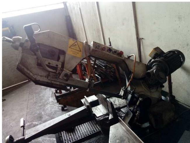
Figura 5- Serrote para corte mecânico
