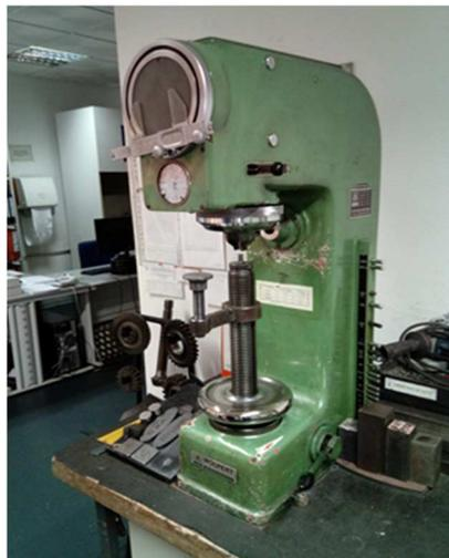
Figura 10- Durómetro Wolpert
