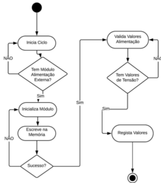
Figura 28- Máquina de Estados - Estado e Ciclos de Alimentação Externa do Dispositivo
