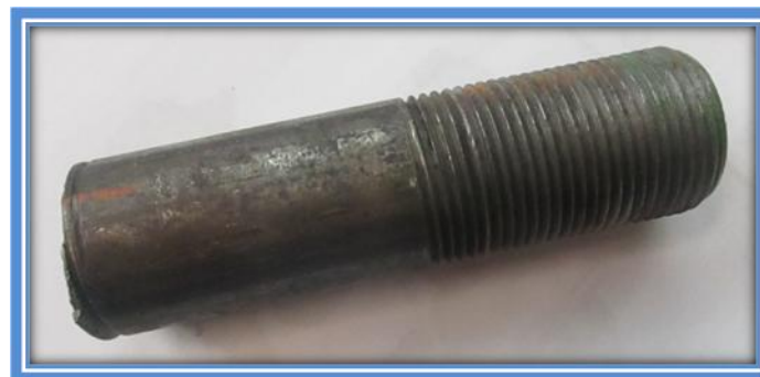
Imagem 30 – Parte do perno fracturado, faltando a extremidade roscada oposta
