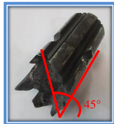
Imagem 19 – Veio fracturado (com um ângulo de fractura de 45 °)
