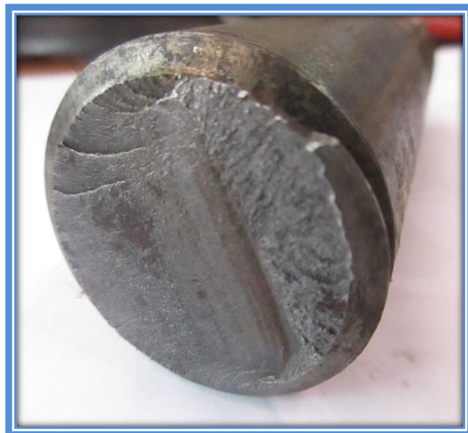
Figura 24 - Superfície de fractura do perno
