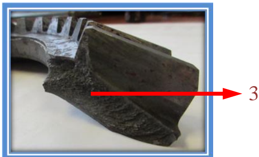
Imagem 23 – Textura da superfície correspondente à fractura final
