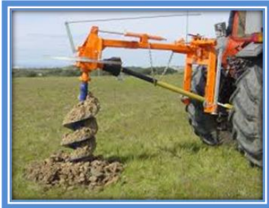
Imagem 20 – Brocadora em serviço
