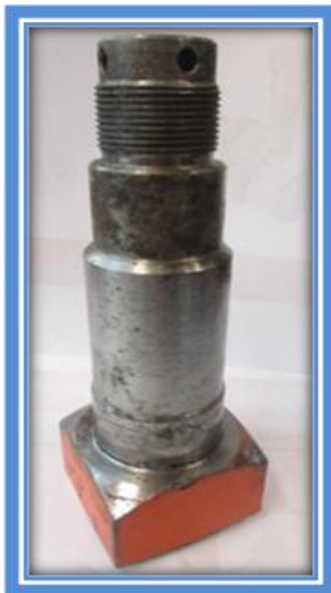
Imagem 15 – Extremidade do eixo fracturado
