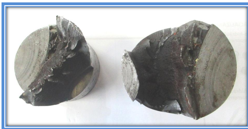
Figura 9 - Dois extremos do veio resultantes da fractura.
