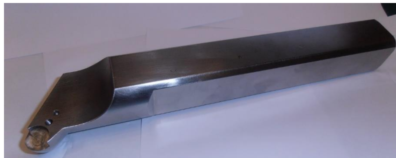
Figura 25: Ferramenta para suporte da pastilha em cerâmica.
