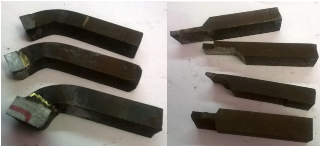
Figura 9: Ferramentas de torneamento com pastilha de metal duro soldada.
