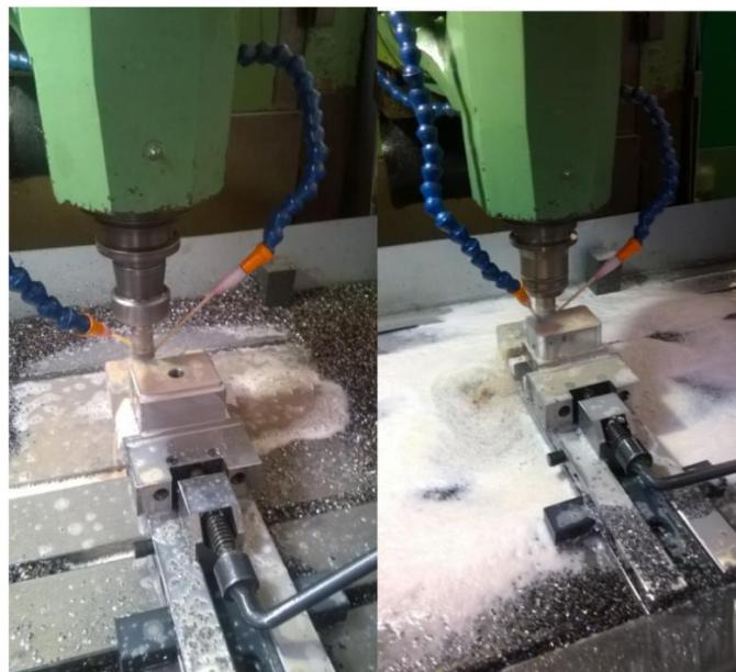
Figura 22: Maquinação de um dos componentes, neste caso a matriz.
