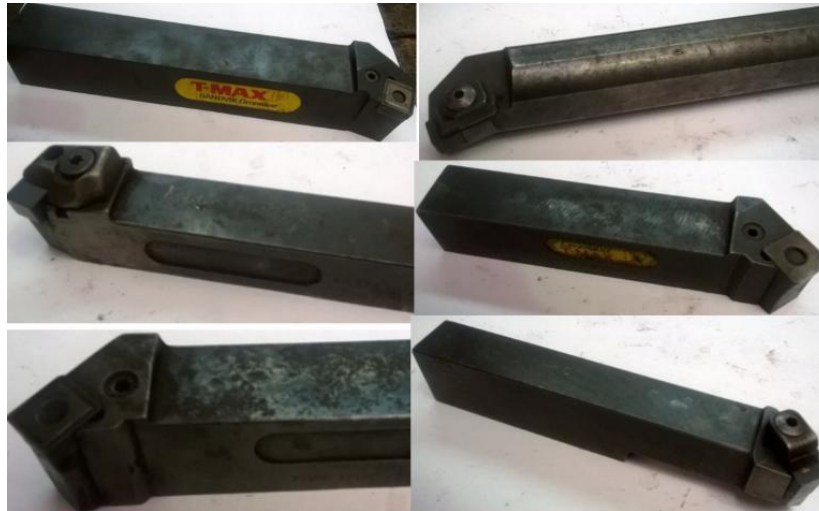
Figura 10: Algumas das primeiras ferramentas de pastilha intercambiável.
