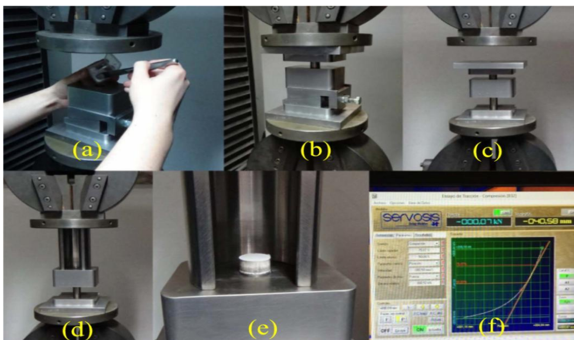
Figura 28: Ciclo de compactação (a) colocação da alumina, (b) pré compactação, (c) compactação, (d) e (e) extração da pastilha, (f) gráfico da compactação.
