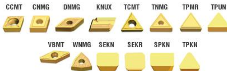
Figura 13: Designação de alguns tipos de pastilha. (fonte Amatoools)
