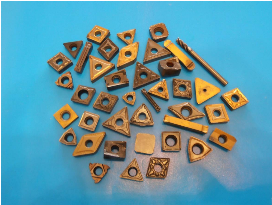
Figura 14: Pastilhas de metal duro, em fim de vida devido ao desgaste, que serão alvo de reciclagem.
