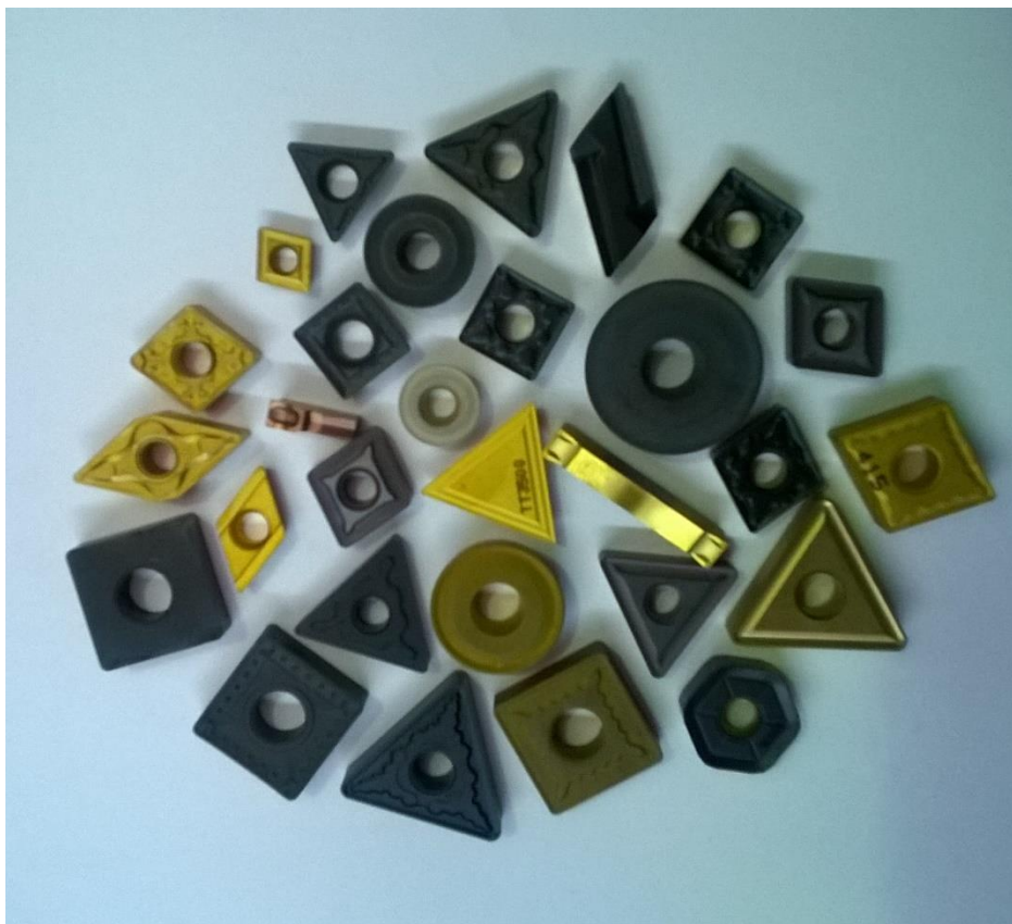
Figura 12: Imagem de alguma das pastilhas utilizadas atualmente.
