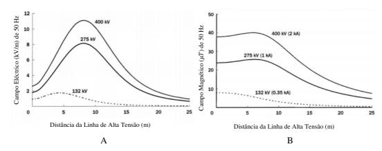
Gráficos 2.2- Medições de campos eléctricos e magnéticos de linhas aéreas de transporte de electricidade de muito alta tensão -132, 275 e 400 kV (fonte: NRPB, 2001 *apud* IARC, 2002) [A] Campo eléctrico (em kV/m); [B] Campo magnético ( $\mu T$ )
