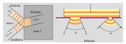
Figura 2.3 – Fenómenos ondulatórios de reflexão, refracção e difracção de uma onda electromagnética Onde: "v" é velocidade de propagação e "α" o ângulo (fonte: www.ifi.unicamp.br)
