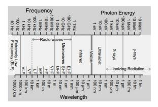
Figura 2.5 - Bandas de frequências, com valores de frequência (em Hz ou *electroVolt* no caso da radiação ionizante) e respectivos comprimentos de onda (fonte: IARC, 2011)
