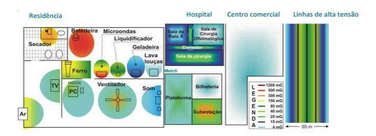
Figura 2.4 - Medições em *miliGauss* (com escala colorida) de valores de campos magnéticos em diferentes locais: residência, hospital, metropolitano, centro comercial e próximo de linhas de alta tensão (fonte: Cabral, s.d., *apud* www.cem.cepel.br/fontes.htm)
