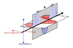
Figura 2.2. - Onda electromagnética com representação dos vectores eléctrico e magnético (fonte: www.vivasemfio.com)
