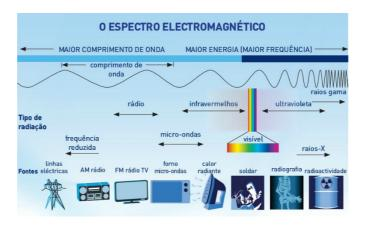
Figura 2.1 - Espectro electromagnético simplificado e principais fontes (fonte: www.ren.pt)
