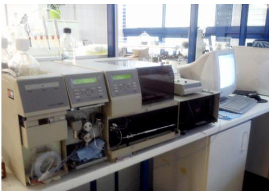
**Figura 19 - Sistema de HPLC.**
