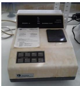
**Figura 16 - Espectrofotómetro Novaspec II Rapid, Pharmacia Biotech.**
