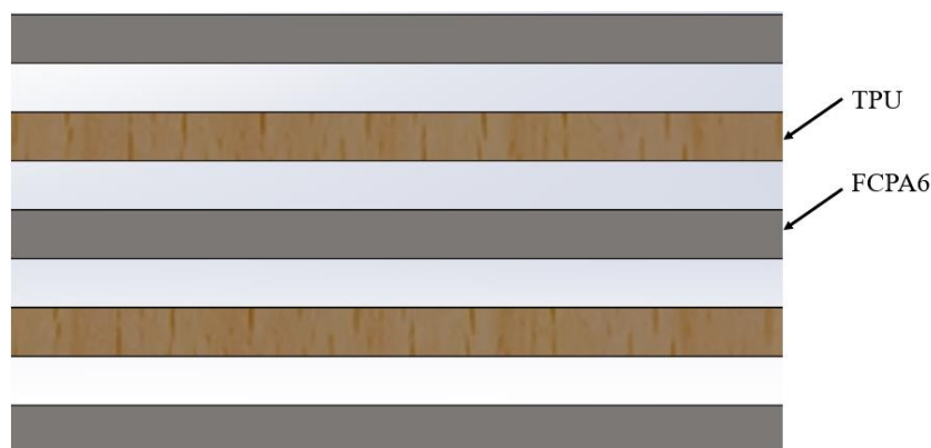
Figura 12 - Esquema de empilhamento com 2 camadas de reforço interlaminar.
