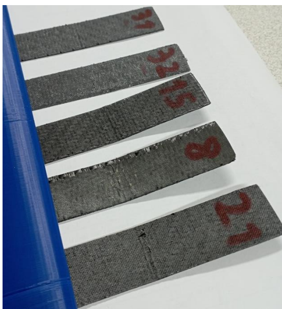
Figura 52 - Deformação dos provetes no ensaio Charpy
