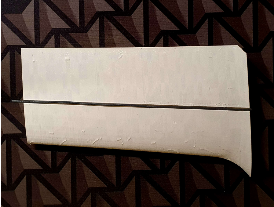
Figura 39: Reforço em viga dos estabilizadores horizontal e vertical.
