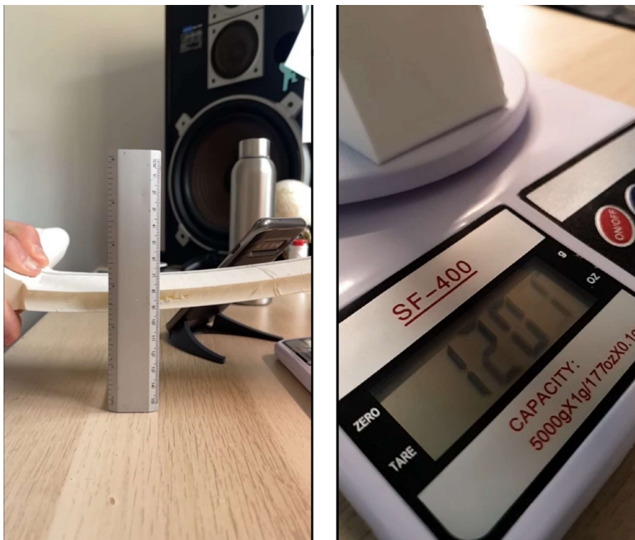
Figura 38: Ensaio destrutivo do estabilizador horizontal. Na imagem à direita é possível observar uma massa na balança de 1200g, indicando uma força equivalente de 11.8N.
