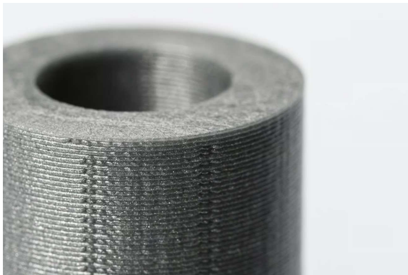
Figura 22: Exemplo de objeto fabricado através da tecnologia FDM onde é visível a deposição de camadas.
