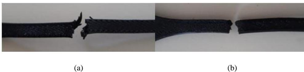
Figura 48 - Fotografias dos provetes impressos a 225°C após a fratura (a) 1 parede externa e (b) 3 paredes externas.
