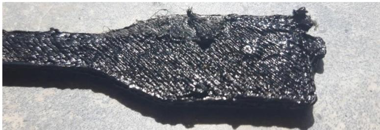
Figura 52 - Fenómeno de “over-extrusion” num provete impresso a 245°C (45°).
