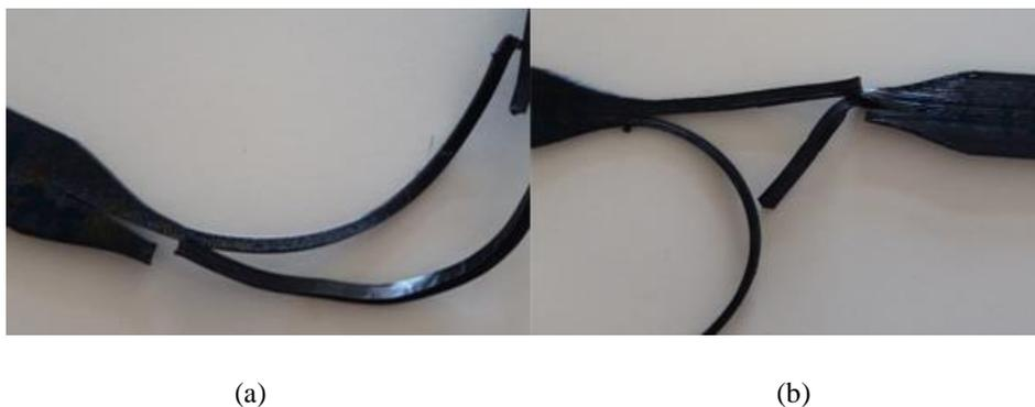
Figura 46 - Fotografias dos provetes impressos a 215°C (a) e a 225°C (b) com ângulos de 0° após a fratura.
