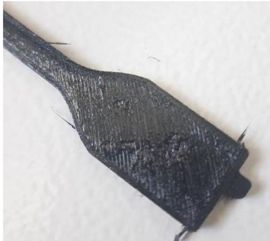
Figura 53 - Provete impresso a 235°C (45°).
