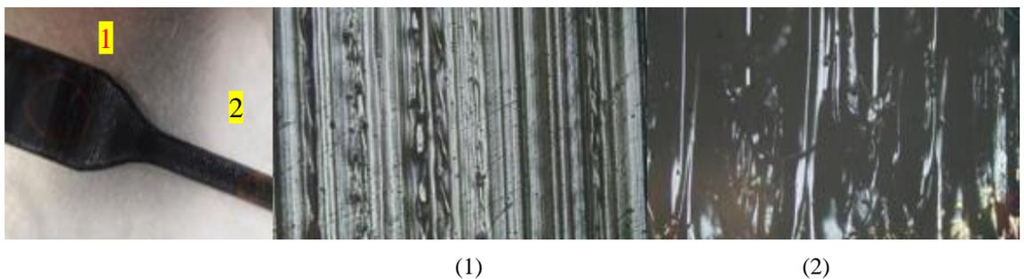
Figura 57 - Imagens microscópicas de um provete impresso a 215°C com ângulo de orientação de 90°, (1) zona 1, (2) zona 2.
