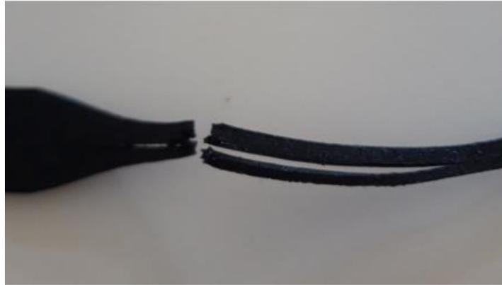
Figura 47 - Fotografia dos provetes impresso a 235°C com um ângulo de 0° após a fratura.
