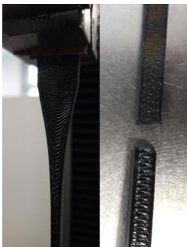
Figura 31 - Máquina Eletromecânica – ensaio de tração do provete com a orientação de 90° e construído à temperatura de 215°C.
