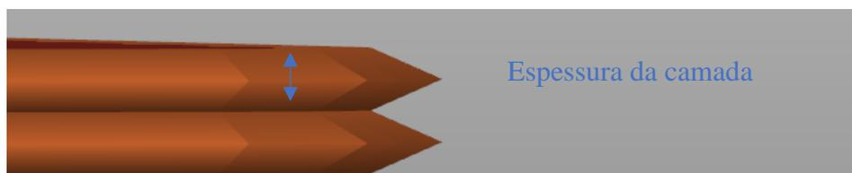
Figura 4 - Representação gráfica da espessura de um provete no *software* PrusaSlicer.
