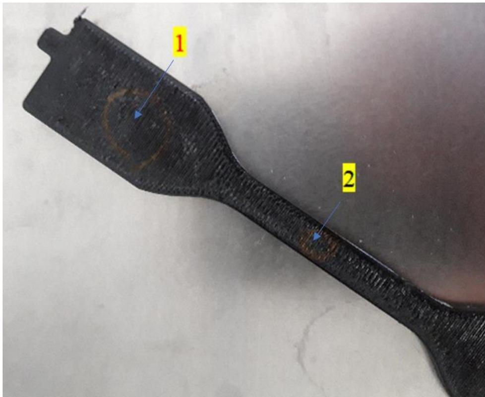
Figura 30 - Provette impresso a 225°C com um ângulo de deposição de 90°.
