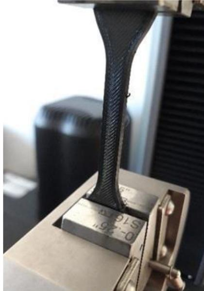
Figura 29 - Provete impresso colocado na máquina Eletromecânica (ensaio de tração)
