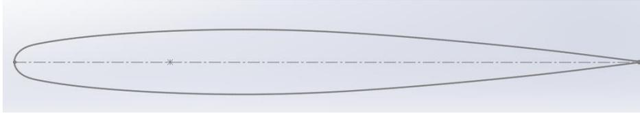
**Figura 14** – Perfil aerodinâmico ONERA M6 (autoria própria, 2023).
