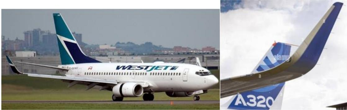
**Figura 5** – *Blended winglets* do B-737-700 (esquerda) e do Sharklet do A-320 (direita)
