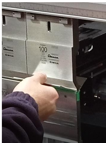
Figura 3.20 – Fotografia do ensaio de controlo à chapa de prova em Al2024
