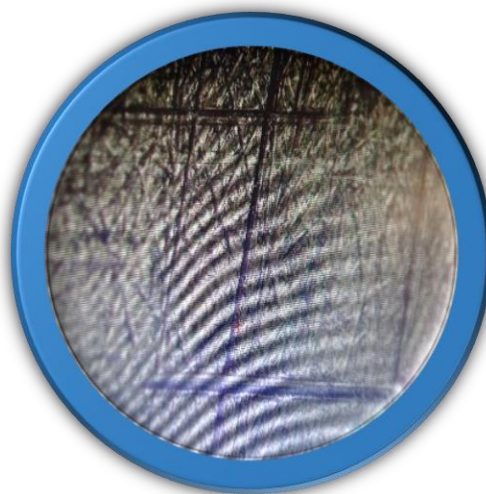
Figura 4.30 – Fotografia de pormenor da chapa nº 425 (1700 quinagens) lado direito (microscópio ótico 100 x)
