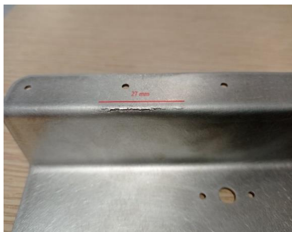
Figura 2.28 – Fotografia do pormenor da fratura com 27mm (imagem 2.1)
