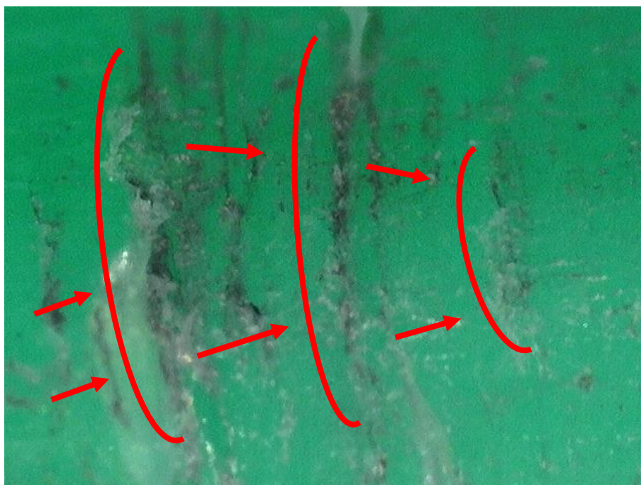
Figura 4.61 – Fotografia do ponto nº 2 da matriz metaloplástica após 1700 quinagens (microscópio ótico digital 50x)
