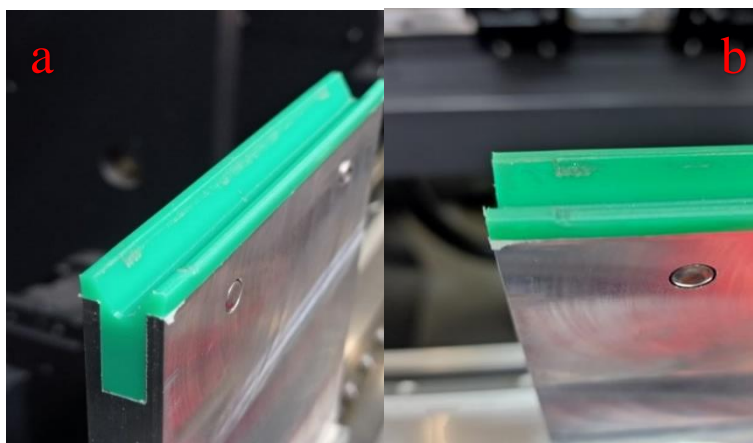
Figura 4.53 – Fotografia de: (a) perfil da matriz metaloplástica, (b) topo da matriz metaloplástica, após 800 quinagens.
