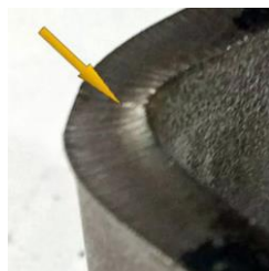
Figura 2.22 – Convexão da borda em relação ao eixo original (HARSLE, 2020)
