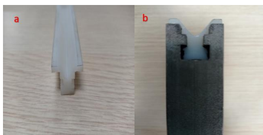
Figura 3.1 - Fotografia de: (a) peça de PTFE para ensaio; (b) matriz em Liga de Fe-C e PTFE
