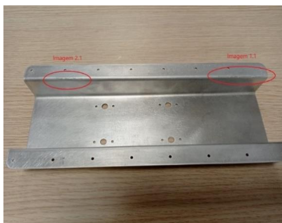
Figura 2.26 – Fotografia do aspecto geral da peça Al2024-T351 fraturada, pós-quinagem
