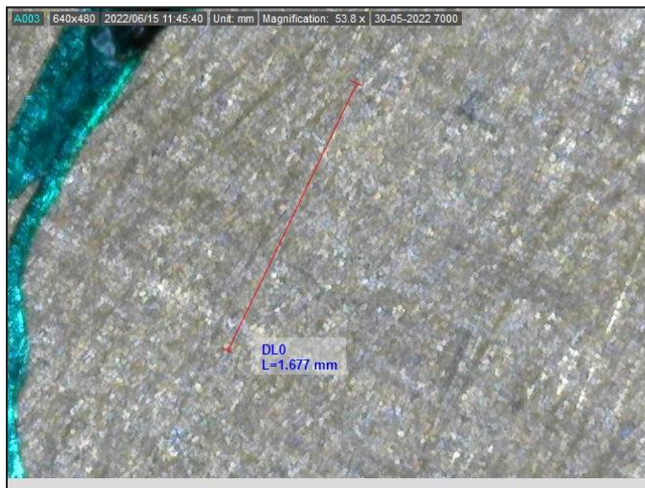
Figura 4.17 – Fotografia da superfície da chapa nº 200 (800 quinagens), lado esquerdo, (vista microscópio digital 53,8 x)
