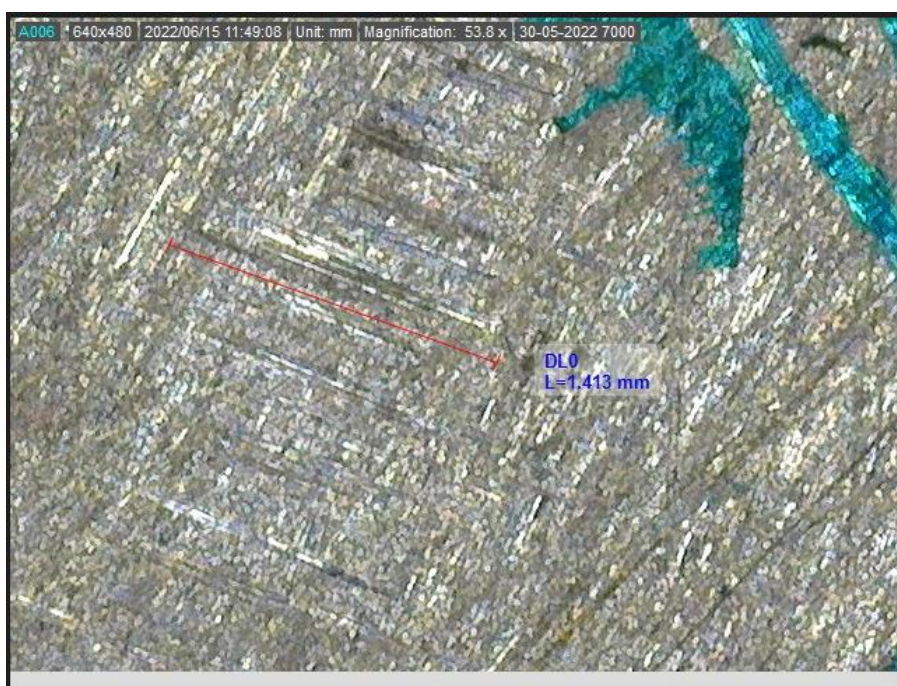
Figura 4.20 – Fotografia da superfície da chapa nº 250 (1000 quinagens), lado direito, (vista microscópio digital 53,8 x)
