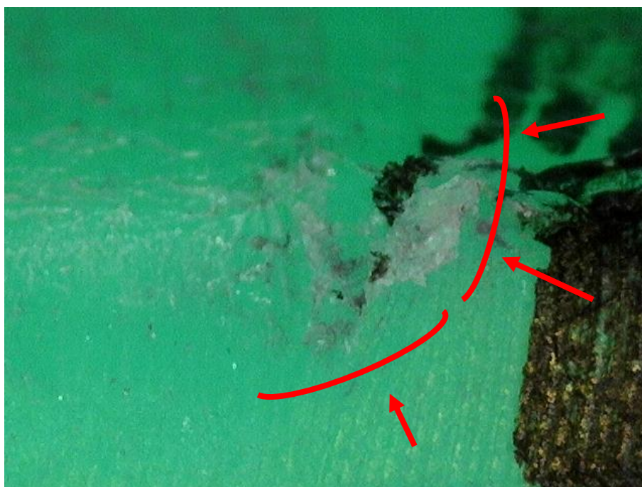
Figura 4.62 – Fotografia do: ponto nº 4 da matriz metaloplástica após 1700 quinagens (microscópio ótico digital 50x)
