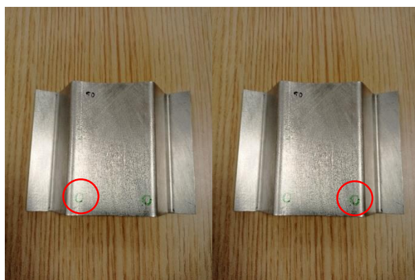
Figura 4.10 – Fotografia das chapas de alumínio após quinagem salientando as zonas de marcação para análise microscópica da superfície (esquerda e direita)
