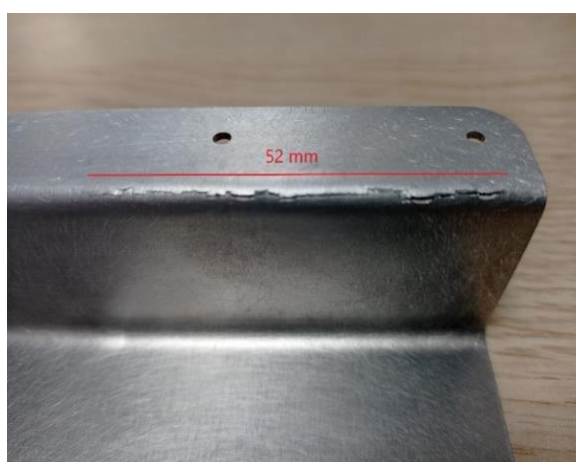
Figura 2.27 – Fotografia do pormenor da fratura com 52mm (imagem 1.1)
