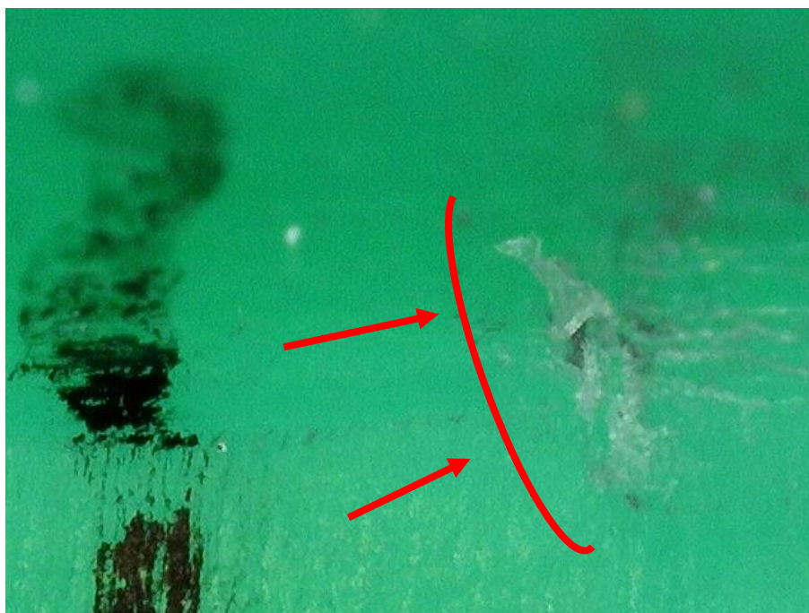
Figura 4.63 – Fotografia do ponto nº 3 da matriz metaloplástica após 1700 quinagens (microscópio ótico digital 50x)
