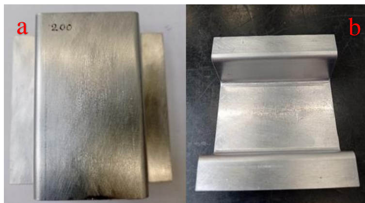
Figura 4.4 – Fotografias das chapas de alumínio: (a) vista de topo, (b) vista de baixo, depois de 800 quinagens (peça n° 200)
