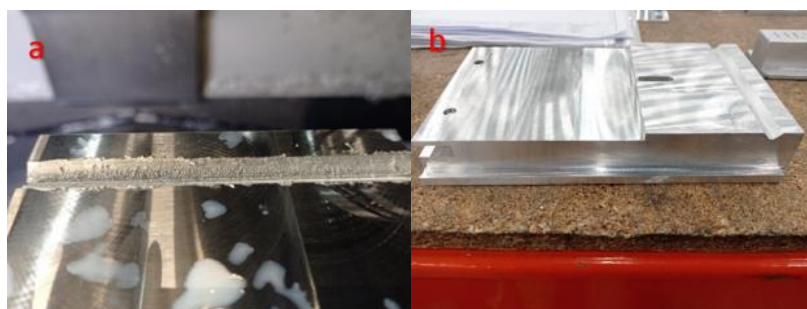
Figura 3.16 – Fotografia de: (a) defeito na superfície do bloco; (b) inspeção da peça semi-acabada
