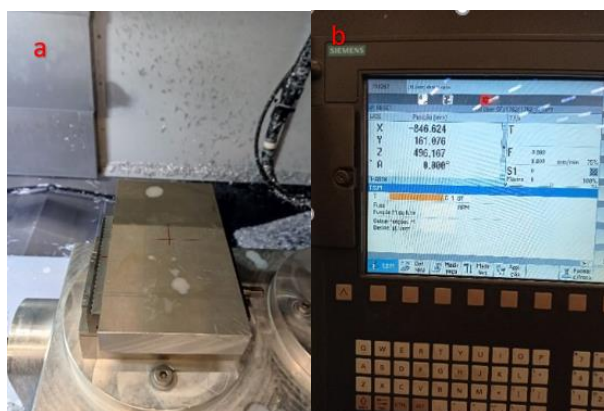
Figura 3.14 – Fotografia da etapa de (a) Fixação do bloco de Al7175; (b) Confirmação de coordenadas no processo de maquinação
