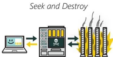
Uma vez passando o tempo de “estudo” do funcionamento do processo, o vírus começava gradualmente a alterar as parametrizações do PLC, fazendo com que as centrifugadoras deixassem o seu normal funcionamento, entrando em regimes prejudiciais para as mesmas.
