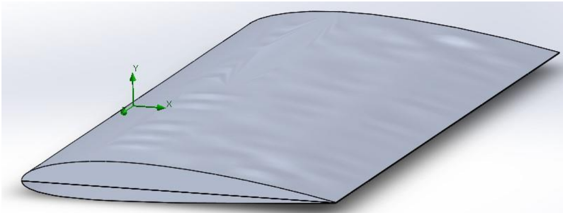
Figura 17 - Perfil NACA 2412 com superfície alterada (teste 3).
