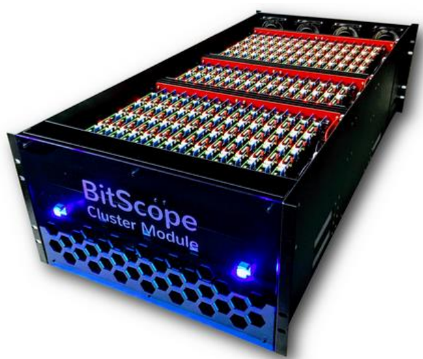
Figura 6 - Um dos Clusters do supercomputador formado por placas de Raspberry Pi 3.
