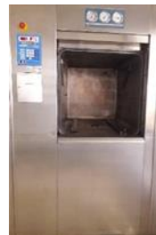
Fig.14 (Esterilizador modelo, Amaro 2000, Capacidade 6 UTE)
