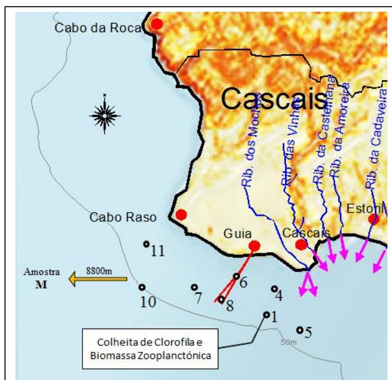
Fig. 1 – Planta de localização dos pontos de recolha das amostras em meio marinho. Imediações do local de descarga do efluente do emissário da ETAR da Guia.
