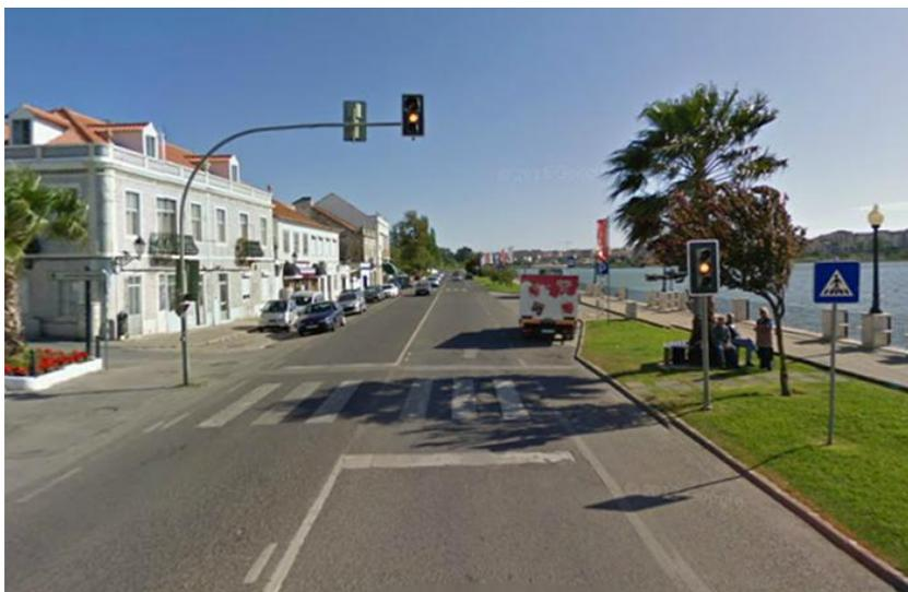
Imagem 16: Sistema semafórico de controlo de velocidade (Fonte: Recolha própria)
