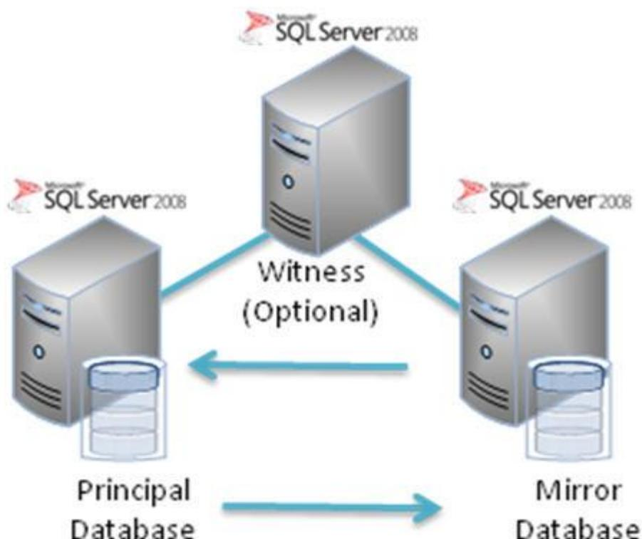
Figura 17. Database Mirroring com máquina witness
